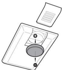
Schuif de deksel van het batterijvak naar beneden en neem de batterij uit de handzender. Plaats de nieuwe batterij (plus-kant naar beneden) en de deksel weer terug.
