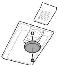
Faites glisser le couvercle du compartiment de la pile de la télécommande manuelle vers le bas et retirez la pile de la télécommande. Insérez la nouvelle pile (symbole « + » vers le bas) et faites de nouveau glisser le couvercle pour le refermer.
