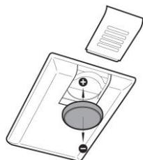
Den Batteriefachdeckel des Handsenders nach unten schieben und die Batterie aus dem Handsender herausnehmen. Die neue Batterie einlegen (Plus nach unten) und den Deckel wieder aufschieben.
