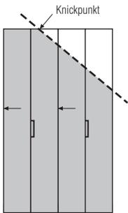
Eine seitliche Abschrägung ist **nur an Elementen** mit **1 Drehtür** bzw. **1 Falлтürenpaar** möglich. Der Türanschlag muss immer an der höher verbleibenden Seite liegen.
